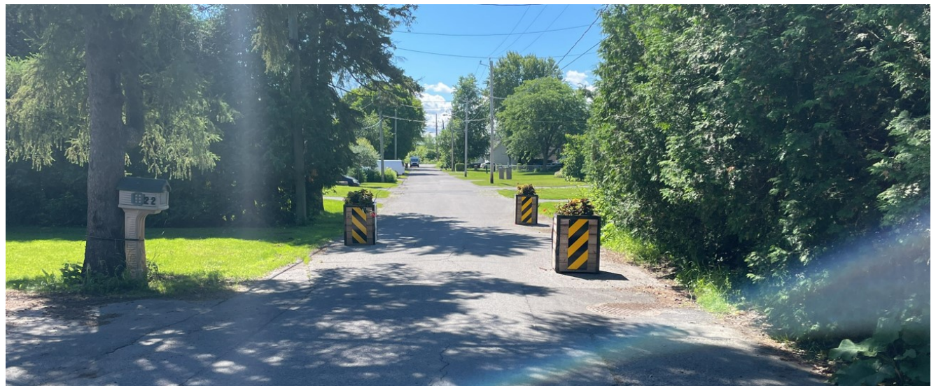
Figure 16 : Bacs de fleurs agissant comme goulot d'étranglement sur la rue De la Gare
